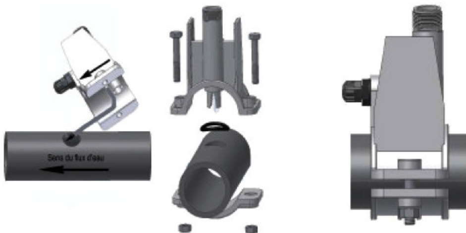
Fig. 2 - Montage du Porte-sonde
